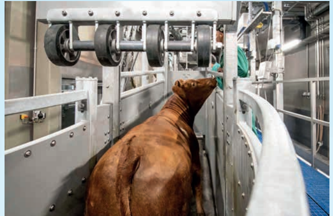
Der Treibgang zur Betäubungsbucht steigt leicht an. So fällt es den Tieren leichter, dorthin zu gehen.
