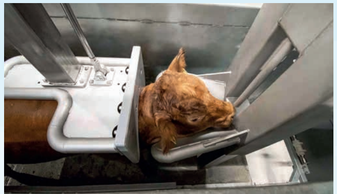
Wichtig bei der Betäubung ist die richtige Fixierung des Kopfes. Der Nackenhalter führt nach unten und die Edelstahl-Kopfaufklappe nach oben. Das Rind kann den Kopf jetzt in keine Richtung mehr bewegen.
